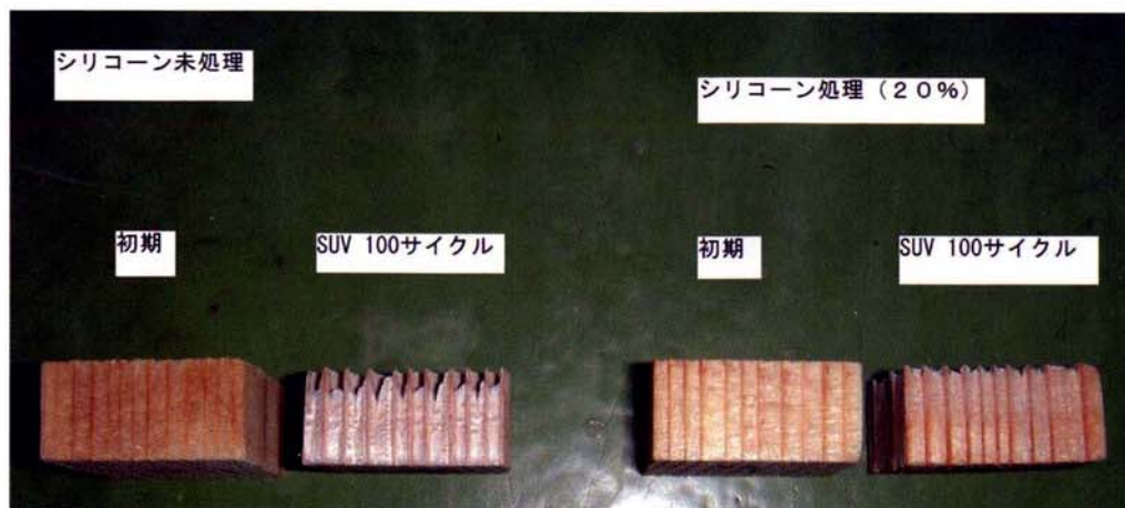
図 3 未処理および処理木材の耐候試験前後の外観
