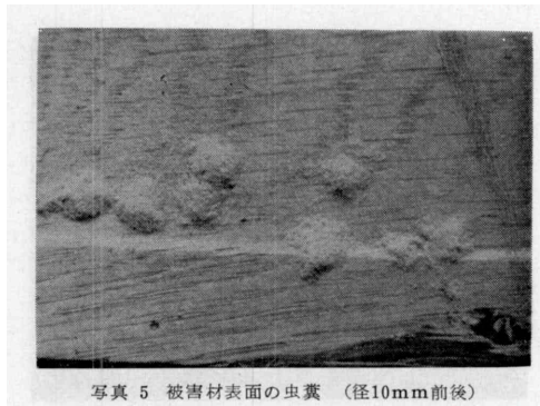
写真 5 被害材表面の虫糞 (径10mm前後)
